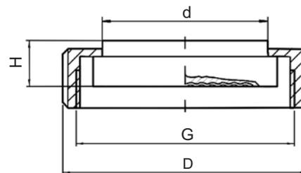
Kegelstutzen B DIN 11887 mit Überwurfmutter F DIN 11851
